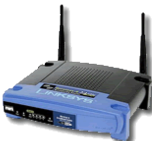
Ruteador (router) de banda ancha inalámbrico de Linksys .
